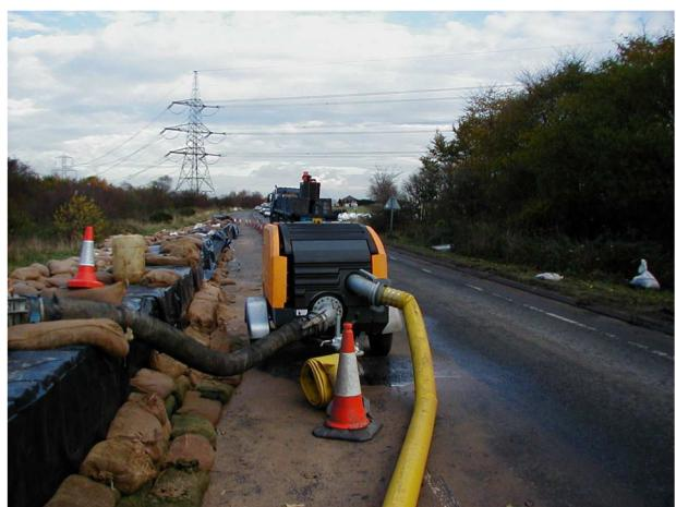
**Pohotovostní čerpadlo při záplavách a haváriích:** SPP<sup>autoprime</sup> lze v případě potřeby rychle přesunout na místo ohrožené záplavami nebo ekologickými haváriemi. V období sucha je možno čerpadlo využít pro zavlažování.
