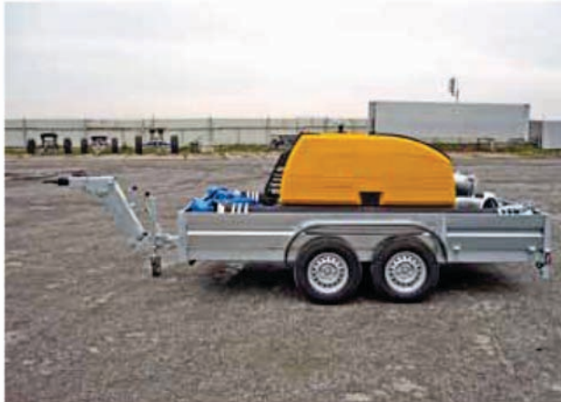
Podvozek pro tato čerpadla vyrobila a.s. PANA V Senice dle specifikace zadavatele tak, aby se na něm mohlo přepravovat i veškeré příslušenství čerpadla. Celková hmotnost agregátu přitom nepřesáhne 2t.
