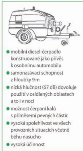
Podvozek pro tato čerpadla vyrobila a.s. PANA V Senice dle specifikace zadavatele tak, aby se na něm mohlo přepravovat i veškeré příslušenství čerpadla. Celková hmotnost agregátu přitom nepřesáhne 2t.
